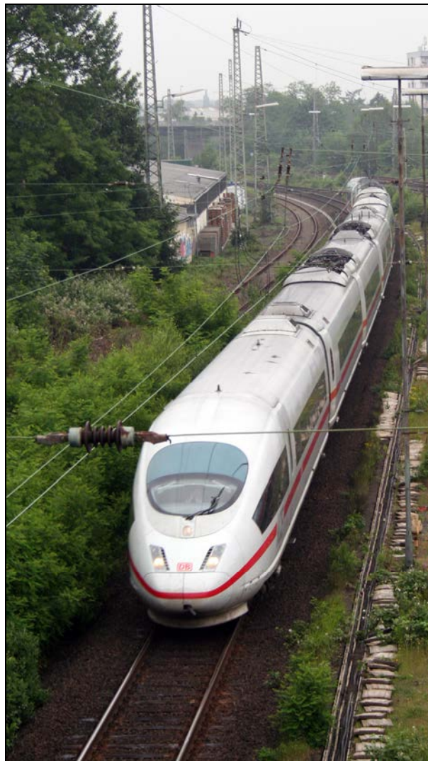
Auf's Dach geschaut: Die ICE 3M der Baureihe 406 besitzen sechs Stromabnehmer - und entsprechend auch sechs Windabweiser auf den Dächern. Die Aufnahme entstand am 15.06.2006 in Wesel. Foto: Dirk Übbing
