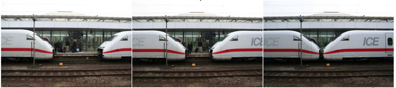
Kuppelvorgang zweier ICE 2-Halbzüge in Hannover Hbf
